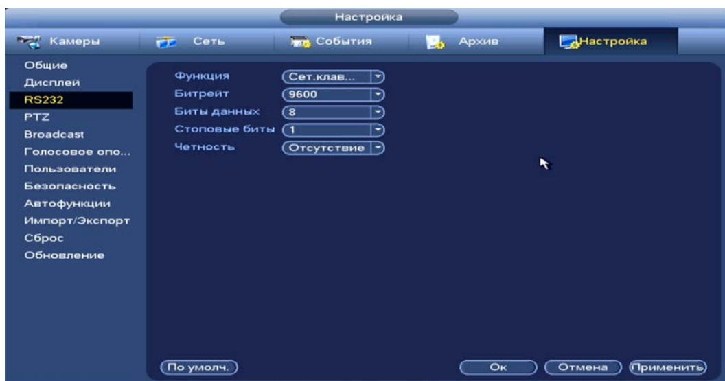
Рисунок 12.8 – Интерфейс настройки соединения подключенного устройства через RS-232
