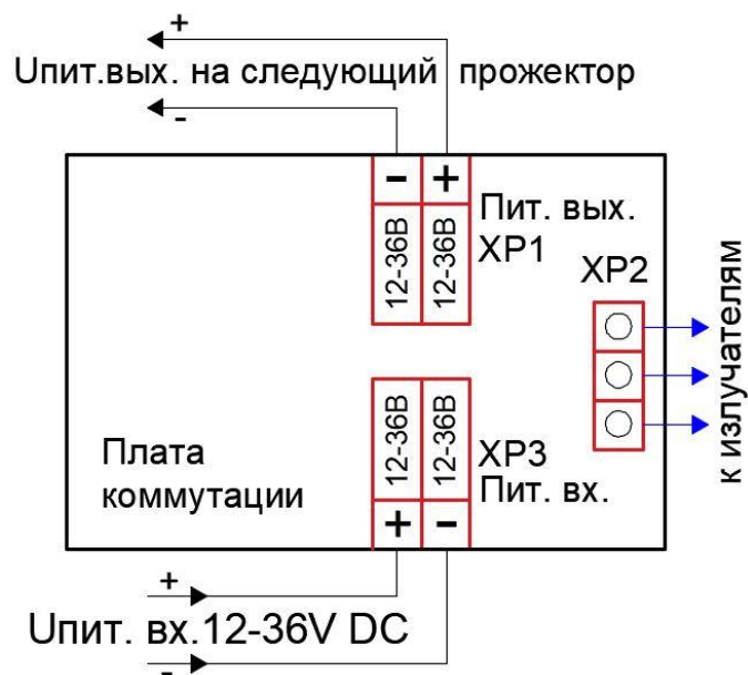
Рисунок 6 – Схема подключения светодиодного прожектора
