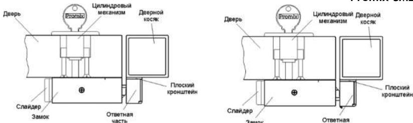
Рис. 6 – Монтаж замка на дверь открывающуюся внутрь
