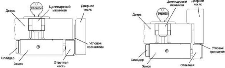
Рис. 5 – Монтаж замка на дверь открывающуюся наружу
