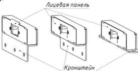
Рис. 4 – Возможные варианты сборки ответной части
