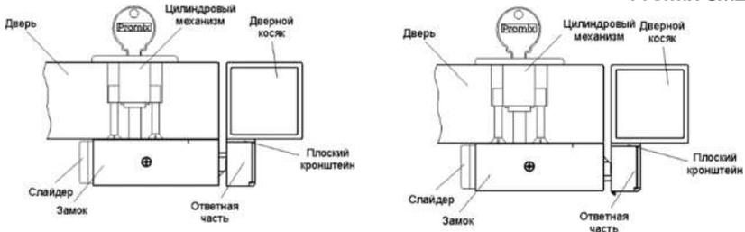
Рис. 6 – Монтаж замка на дверь открывающуюся внутрь
