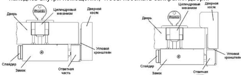
Рис. 5 – Монтаж замка на дверь открывающуюся наружу
