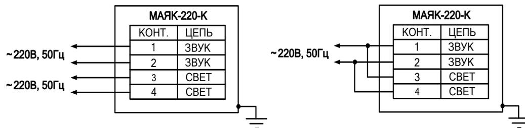
Рис.1. Схема подключения.
