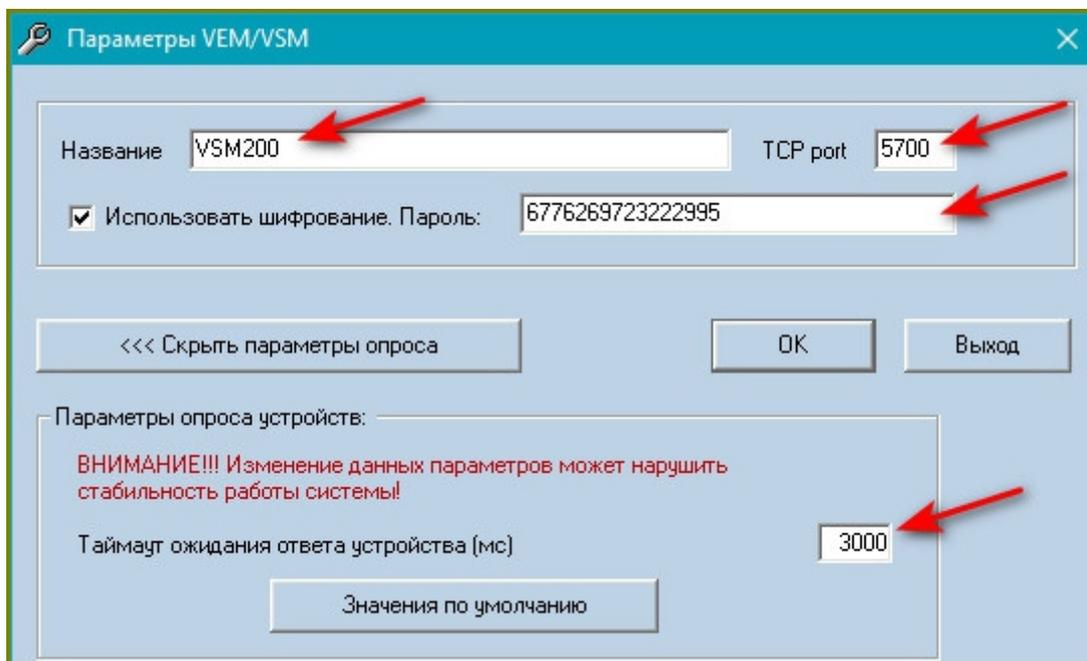
После окончания ввода нажмите «ОК» и в предыдущем окне «Список портов подключения (веток устройств)» отобразится новая запись. Нажмите «Выход».
