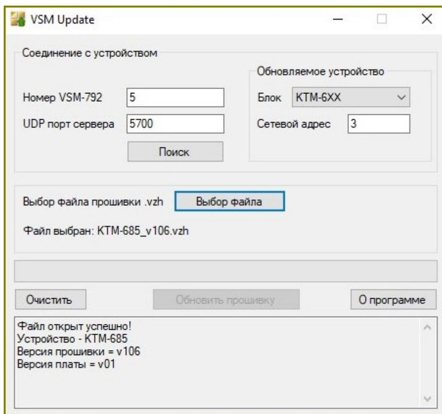
9.3.6. Если заданный модуль был найден и файл обновления открыт успешно, кнопка **«Обновить прошивку»** становится активной. Для начала процедуры обновления нажмите кнопку «Обновить прошивку».
