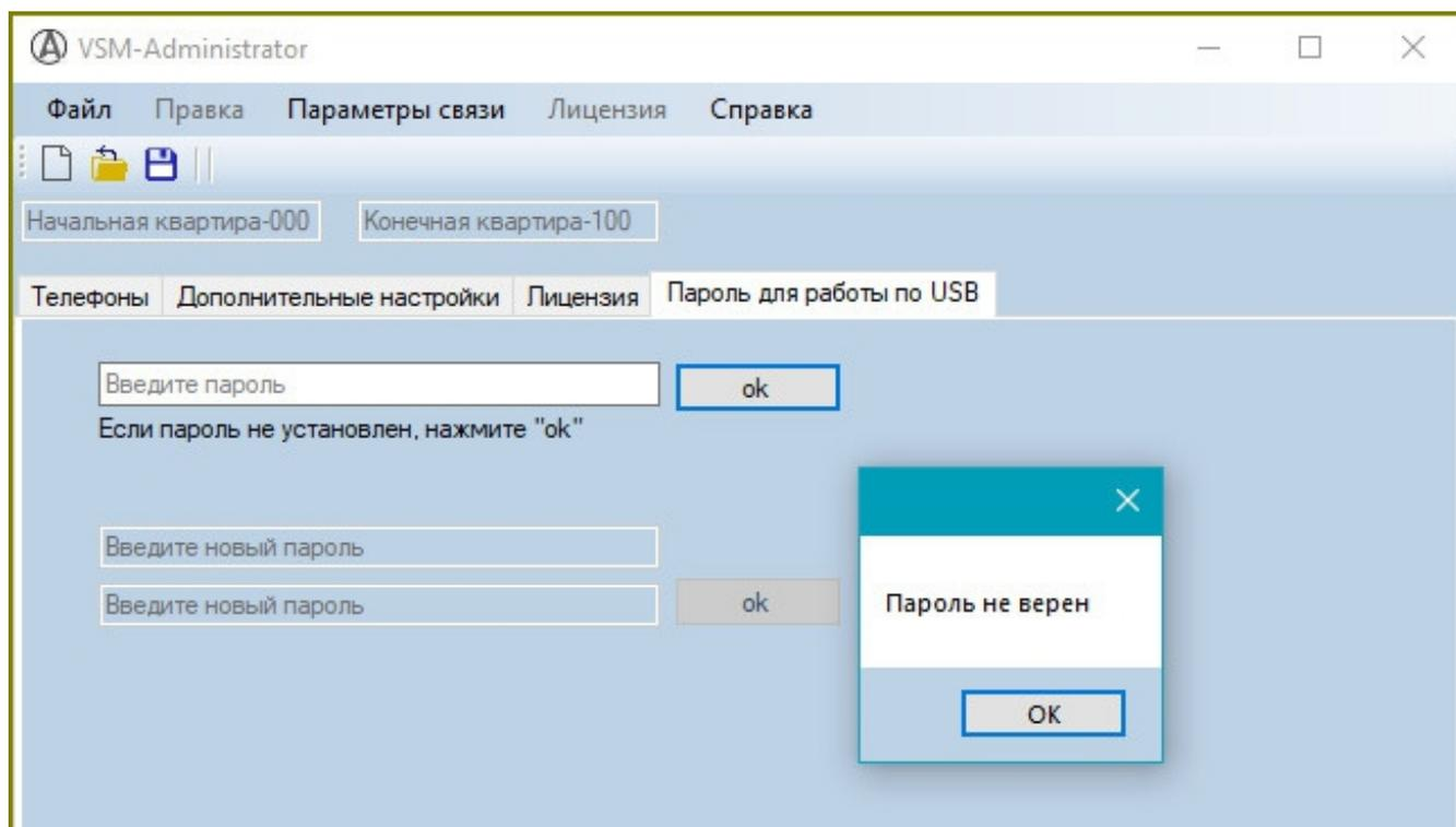
**8.3.4.** Для отключения данной функции необходимо подтвердить существующий пароль, оставить поля нового пароля пустыми, нажать «ок» и перезагрузить модуль.
