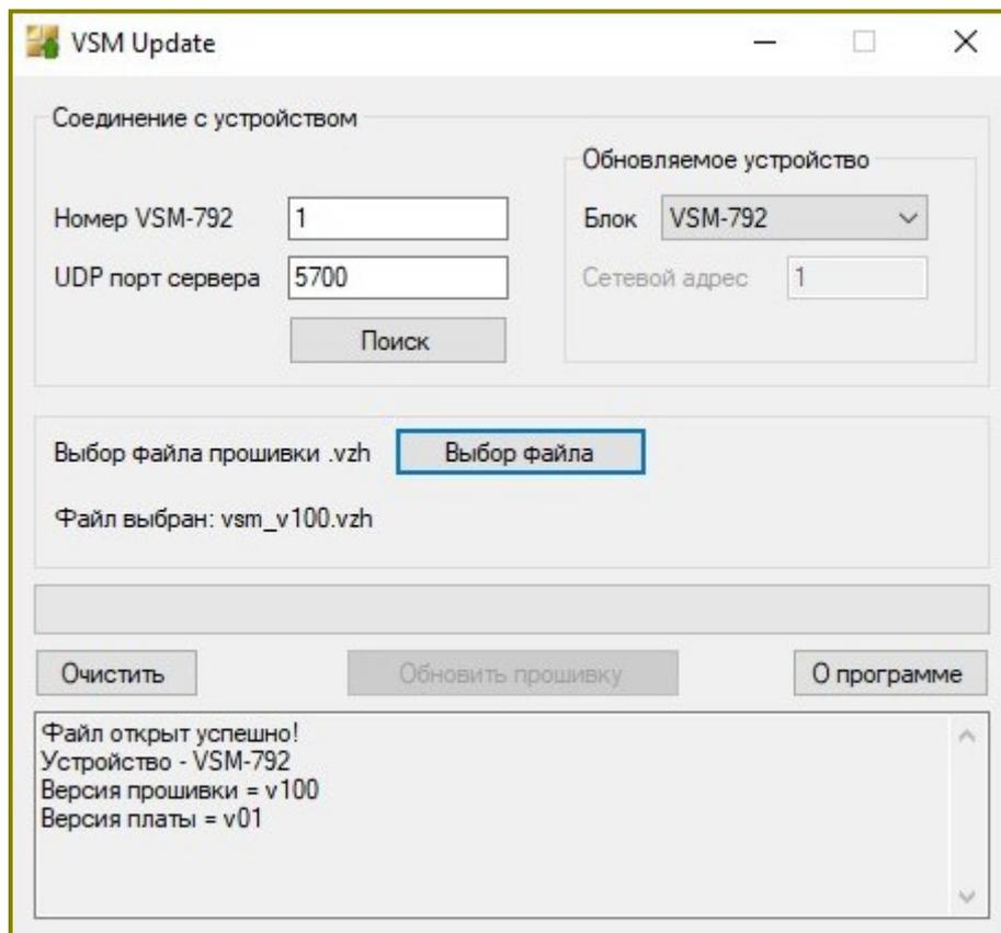
9.2.5. Если заданный модуль был найден и файл обновления открыт успешно, кнопка «Обновить прошивку» становится активной. Для начала процедуры обновления нажмите кнопку **«Обновить прошивку»**.
