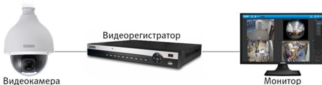
Рисунок 6.2 – Схема подключения видеокамеры
