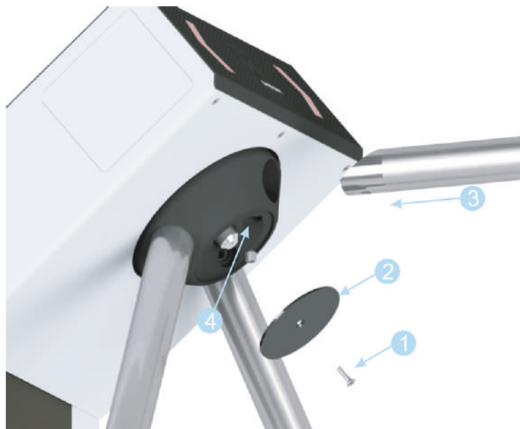
Рисунок 7.5.1 - Установка стандартной преграждающей планки
