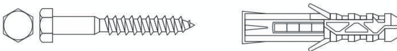
Рисунок 7.4.1 – Шуруп с шестигранной головкой «Глухарь» с дюбелем
