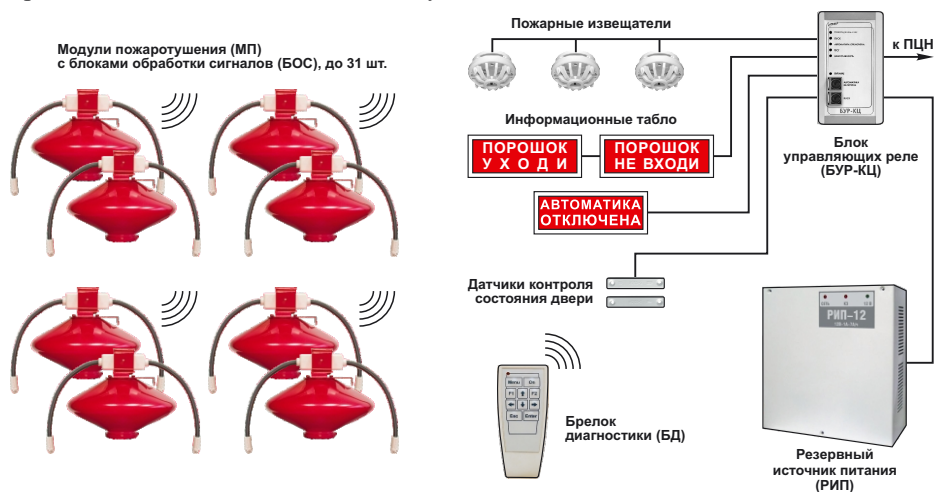
Рис. 4.5. Структурная схема АУП «Гарант-Р» ПО-2 МС
