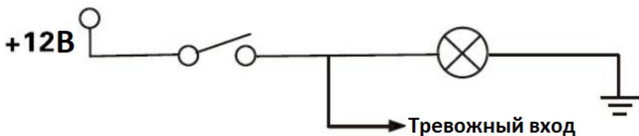
Схема подключения тревожного выхода:
