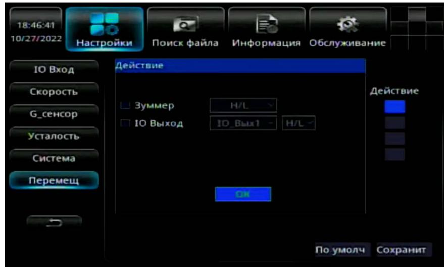
Для работы зуммера требуется чтобы плата устройства была им оснащена, в качестве альтернативы вы можете подключить внешний зуммер на контакты тревожного выхода устройства.
