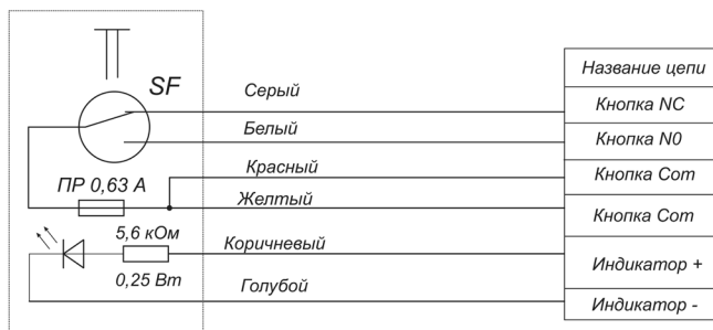
Рисунок 2 – Маркировка выводов изделия ALM-BT-S03
