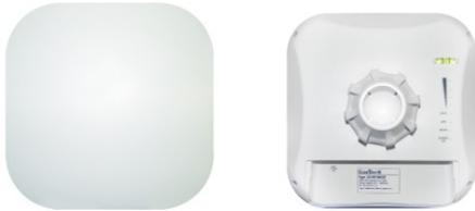
**CO-WF-BR03P** - WiFi Передатчик 5.8G. Вертикальная антенна 16dBi, Усиление до 27dBi. Дальность до 3км. Производительность до 867Mbps. Входы RJ45 10/100/1000 LAN и WAN (оба принимают PoE питание). Управление через IE11 и Cloud. DIP переключатели. Питание от POE 48V, потребление до 7W (блок питания в комплект не входит). Температурный диапазон -40°C ~ +65°C, IP65, вес 830г, размеры 205x205x130мм. Пластиковый кожух. Комплект для установки на стену и столб.
