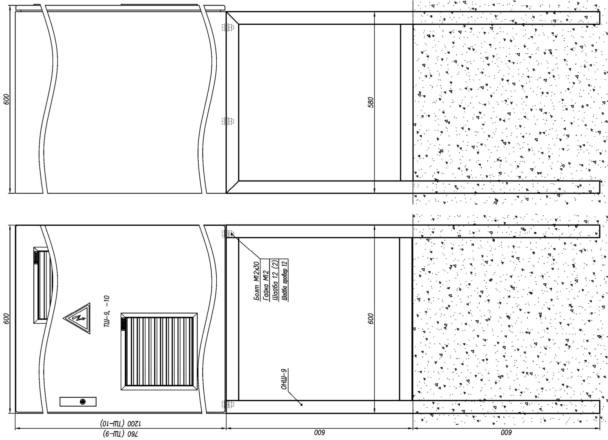
Рис.1 Габаритные и установочные размеры основания напольного ОНП-9
