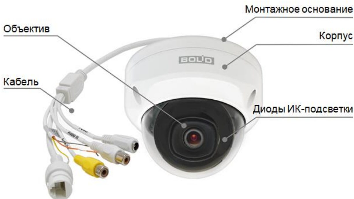
Рисунок 4.1 – Внешний вид и основные элементы видеокамеры
