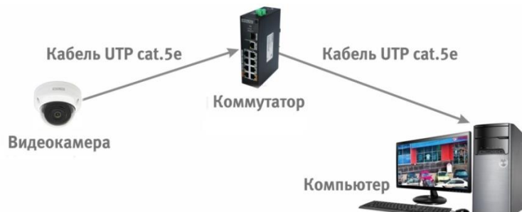
Рисунок 6.3 – Схема подключения видеокамеры к компьютеру через коммутатор
