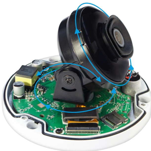
Рисунок 5.7 – Настройка направления объектива
