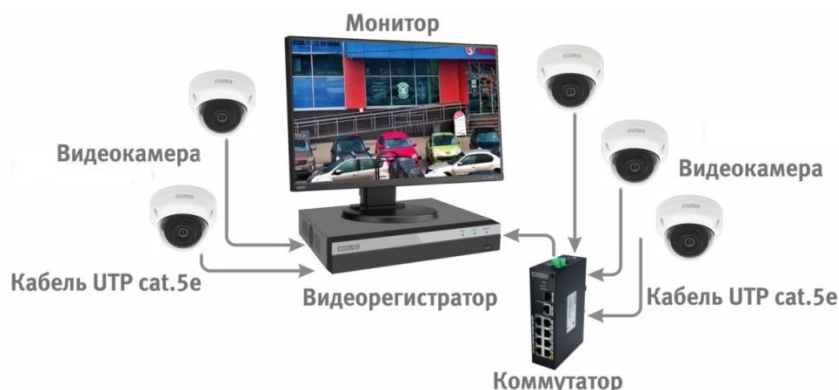
Рисунок 6.4 – Схема подключения видеокамеры к видеорегистратору
