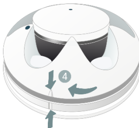
Рисунок 9.2 – Закрепление корпуса датчика
