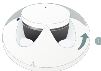
Рисунок 6.2 – Вскрытие корпуса датчика
