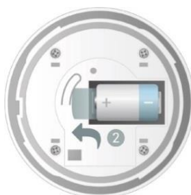
Рисунок 6.3 – Удаление защитной пленки
