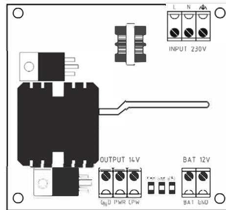
Рисунок 1. Внешний вид источника питания и назначение разъёмов
