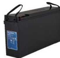
CSB серии TPL122000 - герметизированные, выполненные по технологии AGM, батареи с фронтальным расположением выводов и сроком службы до 12 лет при 25°C. Используются в качестве резервного питания для телекоммуникационного оборудования, медицинского оборудования, в системах пожарной и охранной сигнализации, источниках бесперебойного питания (UPS) различной мощности. По своим габаритным размерам они могут размещаться в специальных 23-дюймовых батарейных шкафах.
