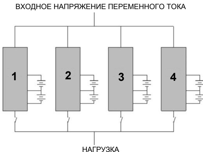
Рисунок 25 - Схема подключения изделий в систему параллельного резервирования
