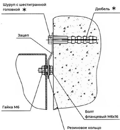
Рисунок 3 - Установка на стену без зацепов
