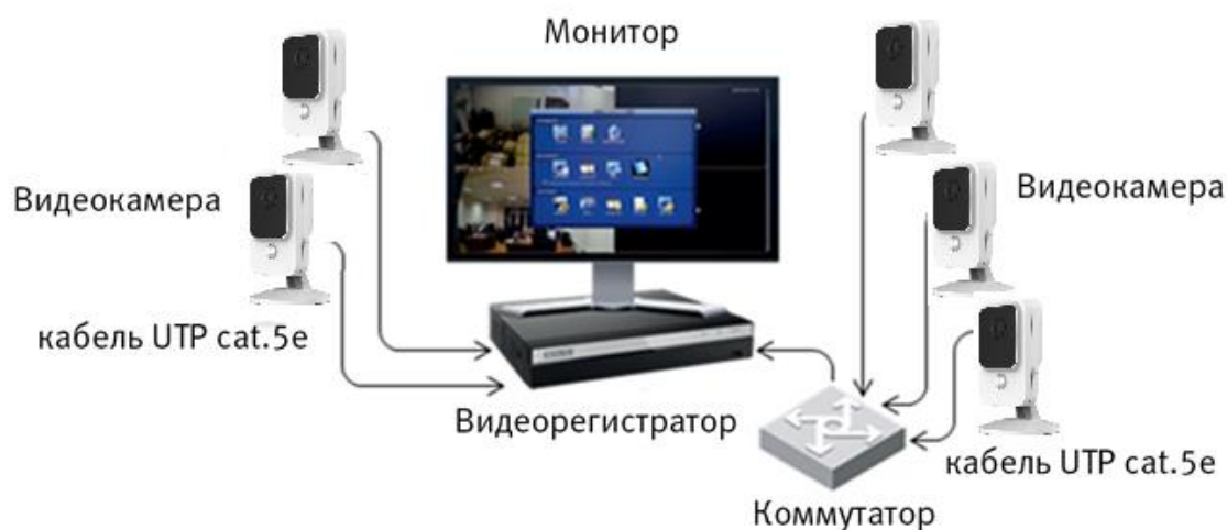
Рисунок 5.5 – Схема подключения видеокамеры к видеорегистратору
