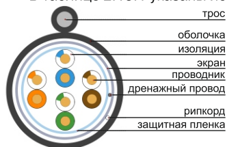
Рисунок 2.13.1 – Конструкция кабеля BC3-C5E04-359-305-G
