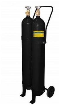
Мобильный пусковой блок МПБ-14 представляет собой двухколесную тележку с расположенными на ней двумя пусковыми баллонами с массой углекислого газа по 7 кг в каждом. Обеспечивает длительную и безопасную автономную работу установки с возможностью настройки расхода жидкости при помощи редуктора (от 1 до 2 л/мин).
