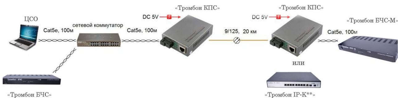
*Рисунок 2 - Схема подключения для «Тромбон СДУ»*
