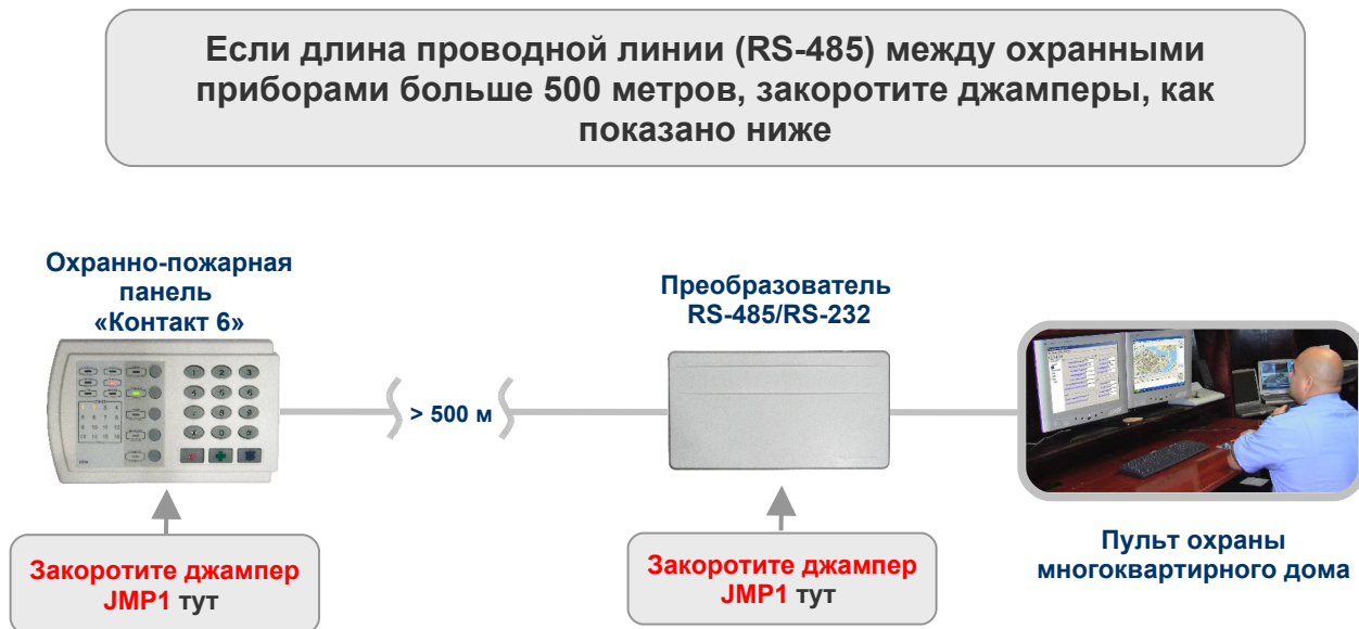
Рис.6.10. Состояние джамперов (JMP1) «Контакта 6» и преобразователя RS-485/RS-232 в зависимости от длины проводной линии (RS-485) между ними.
