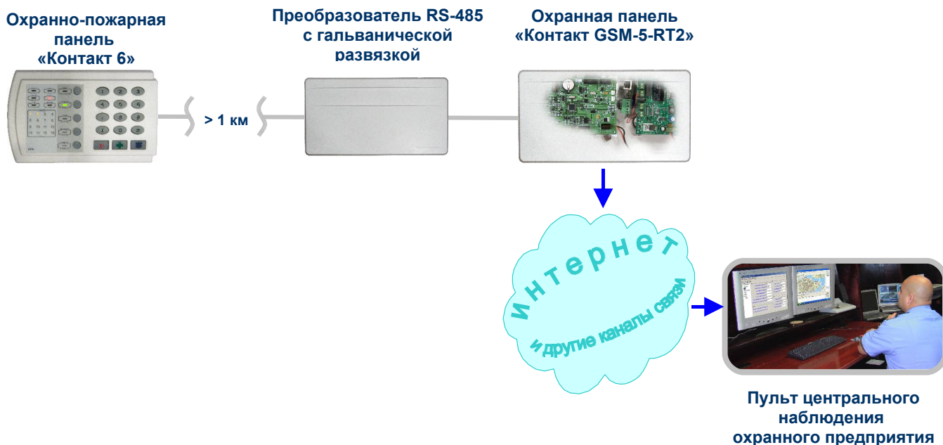
Рис.1.4. Состав приборов для типового решения №2 в зависимости от длины проводной линии (RS-485) между ними.
