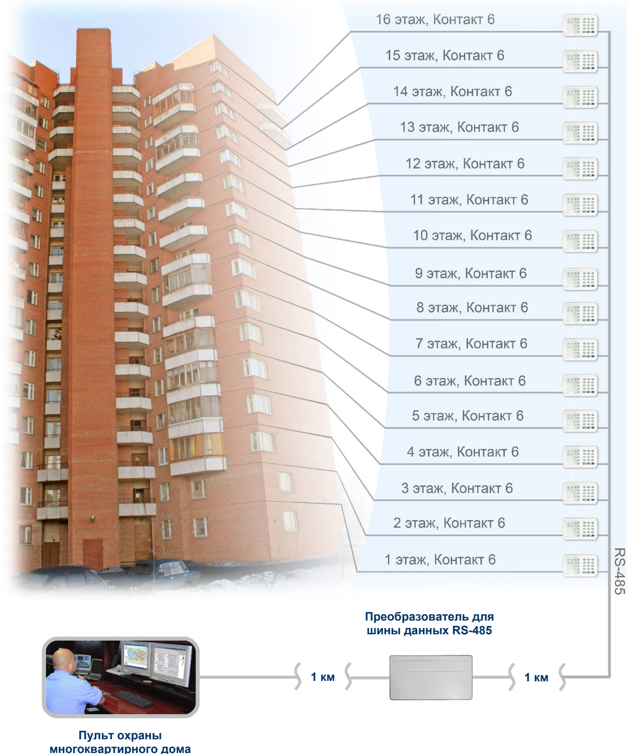
Рис.6.1. Принцип работы преобразователя RS-485 с гальванической развязкой.
