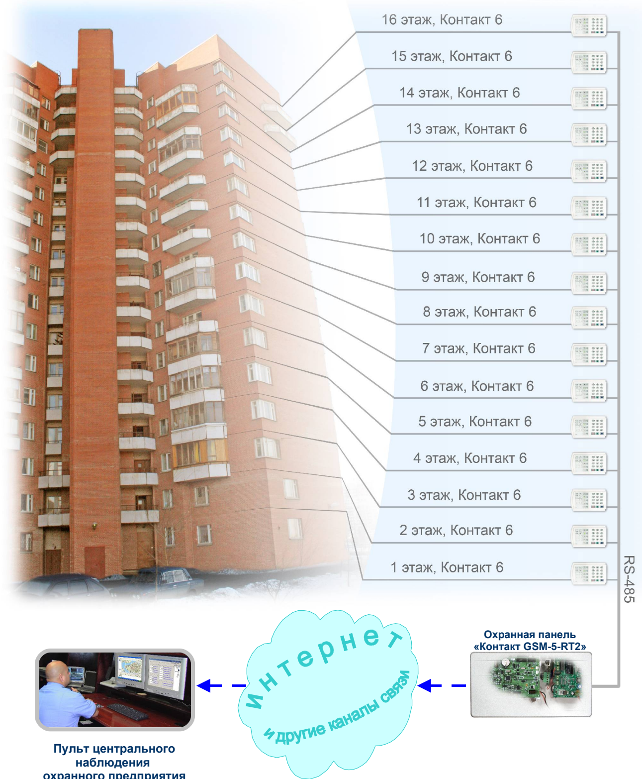
Рис.1.3. Типовое решение №2. Использование «Контактов 6» для охраны многоквартирного дома ТСЖ. Сообщения от панелей передаются на пульт центрального наблюдения охранного предприятия
