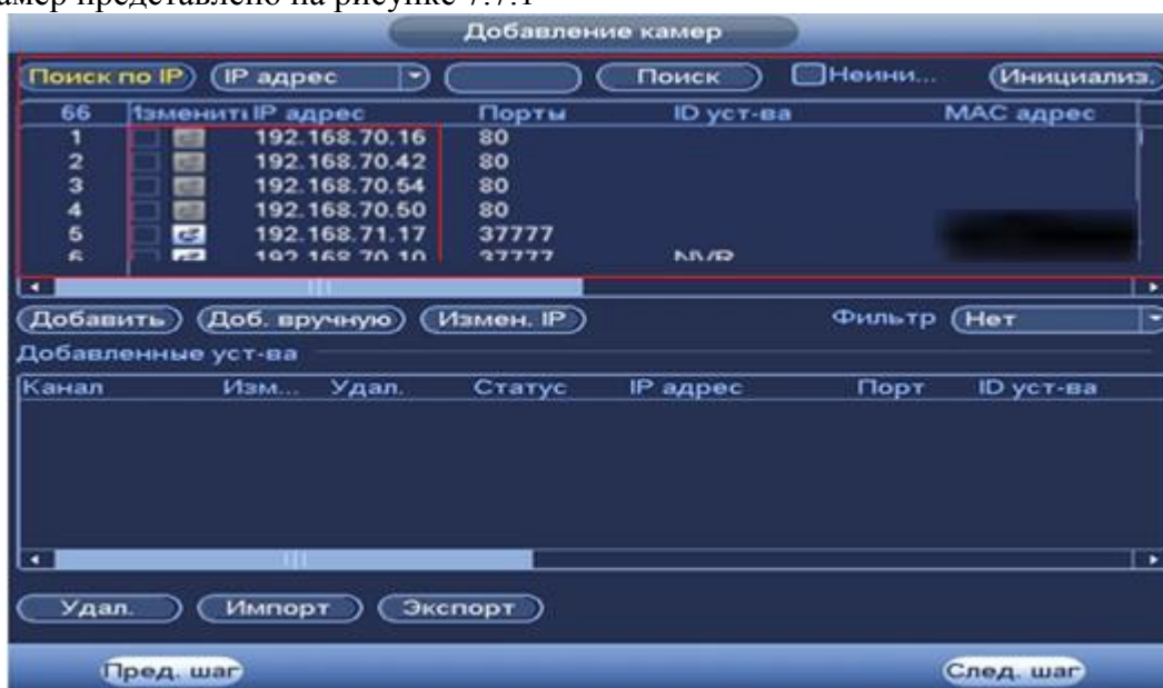
Рисунок 7.7.1 Настройка добавления камер по поиску в сети.
