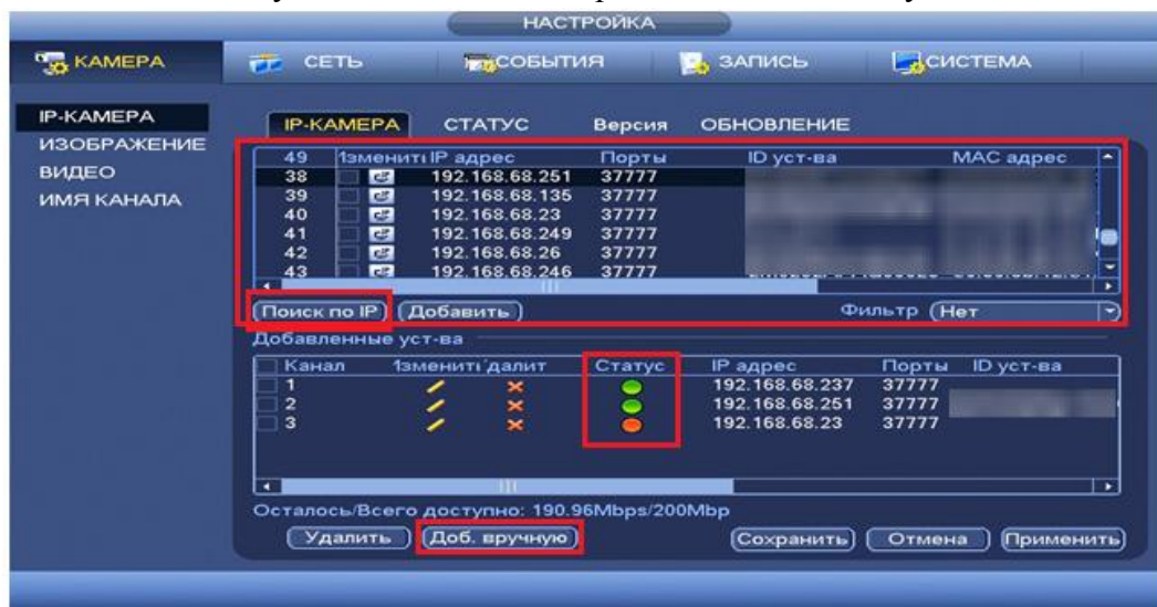
Рисунок 8.3.1.1.1.2 Настройка добавления камер по поиску в сети.
