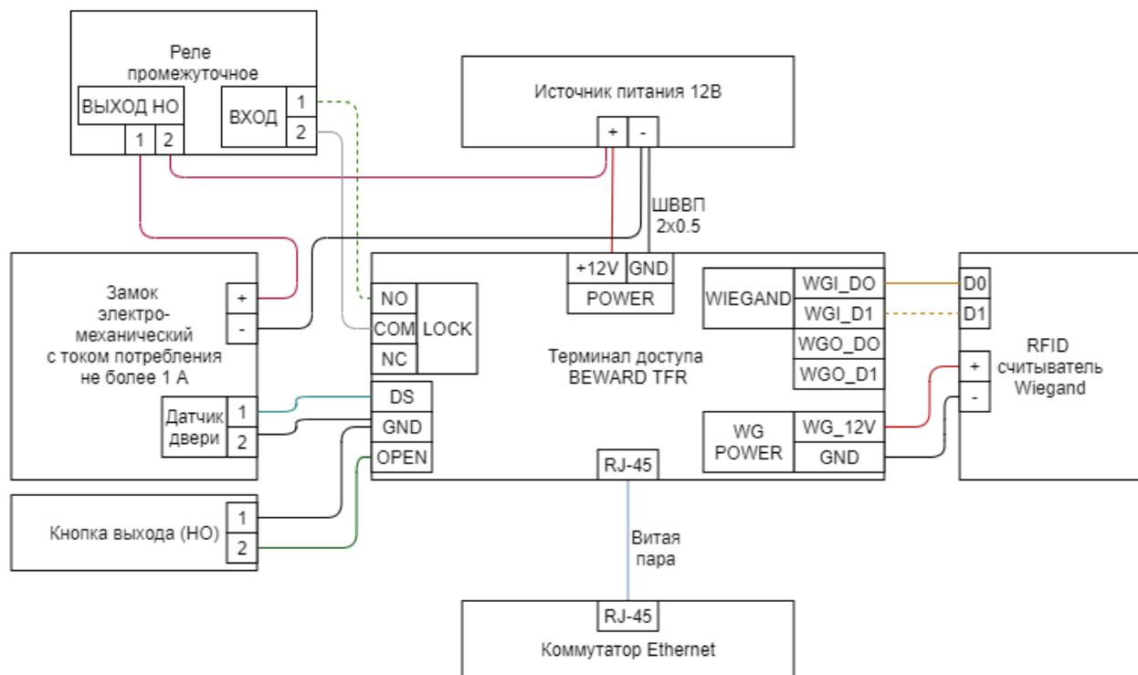
Если терминал доступа BEWARD выступает в роли считывателя на точке прохода, то при успешной идентификации сотрудника на терминале, от терминала на сторонний контроллер доступа может быть передан заранее закреплённый за сотрудником Wiegand-код, идентифицирующий сотрудника в стороннем контроллере (см. руководство по эксплуатации терминалов доступа Reward TFR на сайте [reward.ru](http://reward.ru)). Для этого необходимо задействовать разъёмы Wiegand выход на терминале:
