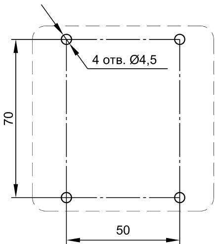
**Рис. Д.1** Разметка для крепления модулей «МИП-М(-Ex)», коробок КСРВ-и и коробок КСРП.
