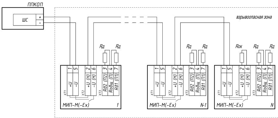
Размещение извещателей с блоком обработки «МИП-М» во взрывоопасной зоне недопустимо.
