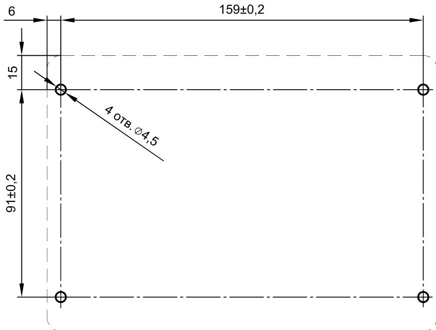
**Рис. Д.2** Разметка для крепления модулей «МИП-М(1...2)И(-Ex)»
