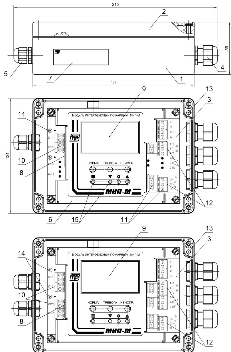
**Рис. В.1.** Внешний вид модулей МИП-М(1...2)И(-Ex).
