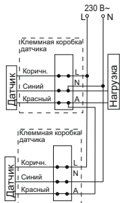
Рисунок 6 – Схема параллельного подключения датчиков движения
