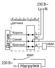
Рисунок 8 – Схема подключения датчиков с контактором КМИ
