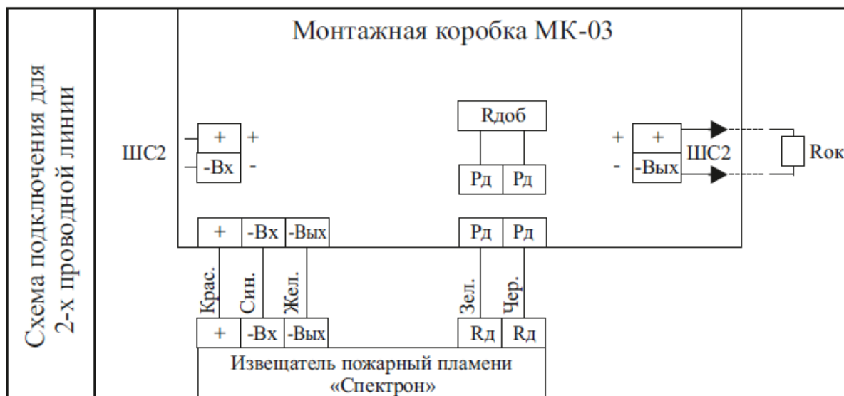
Рис.3. Схема подключения извещателей только по 2-х проводной схеме
