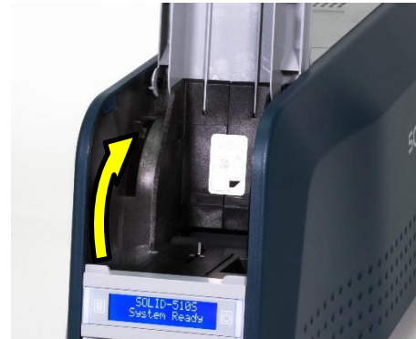
Рис. 24 Механизм настройки толщины карт
