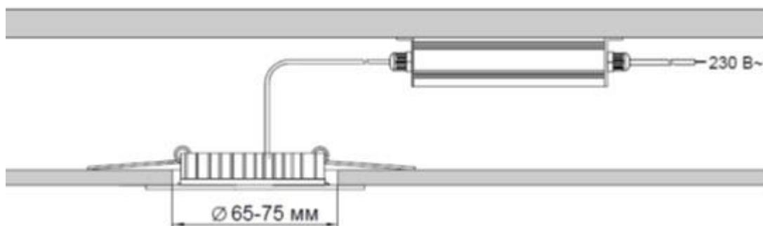
2. В случае если межпотолочного пространства недостаточного для установки источника питания в отверстие для монтажа светильника с малым кольцом, монтаж светильника выполняется в отверстие диаметром 75-125мм (большое кольцо корпуса).
