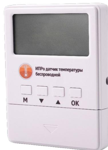
**«ИПРО-Термостат»** – это система управления температурой состоящая из «ИПРО-Радиореле»(приемный блок) и «Беспроводного датчика температуры ИПРО». Реле подключается к электронному блоку управления котлом. При изменении температуры помещения управление происходит путем замыкания/размыкания управляющих контактов отопительного оборудования (режим внешнего термостата).
