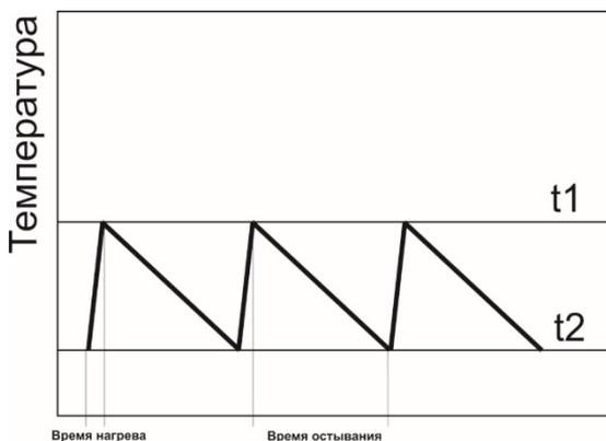
Данный параметр устанавливает разницу между температурой включения и выключения отопительного оборудования. Диапазон регулировки от 0,1 до 2 градусов. По умолчанию установлено значение 0,5 градуса.
