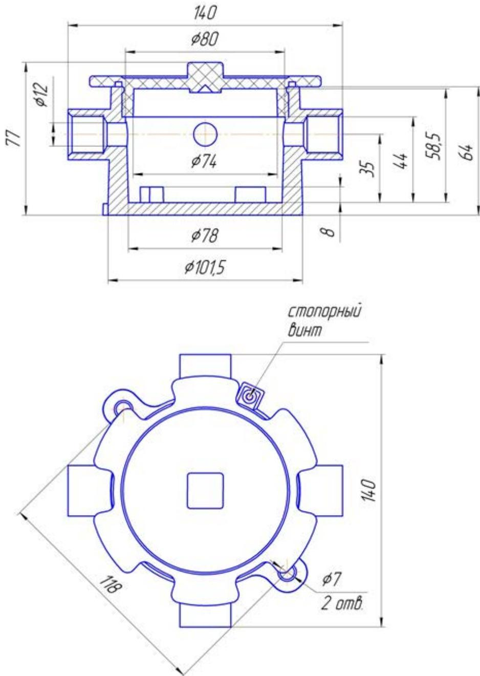
Рис. А1 – Габаритные и посадочные размеры коробки
