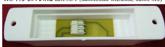
ИО 102-26 АЯКС исп.03/2 (клеммы экспрессмонтажа)
