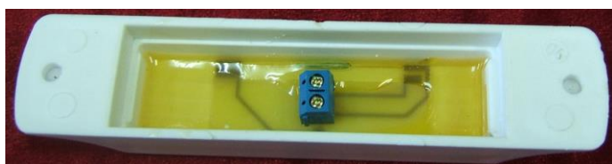
ИО 102-26 исп.01 АЯКС (внутренний разъём DG3)
