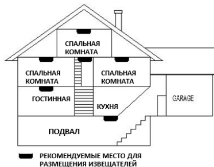
Рисунок 5 – Схема расположения Извещателей в многоэтажном жилом здании
