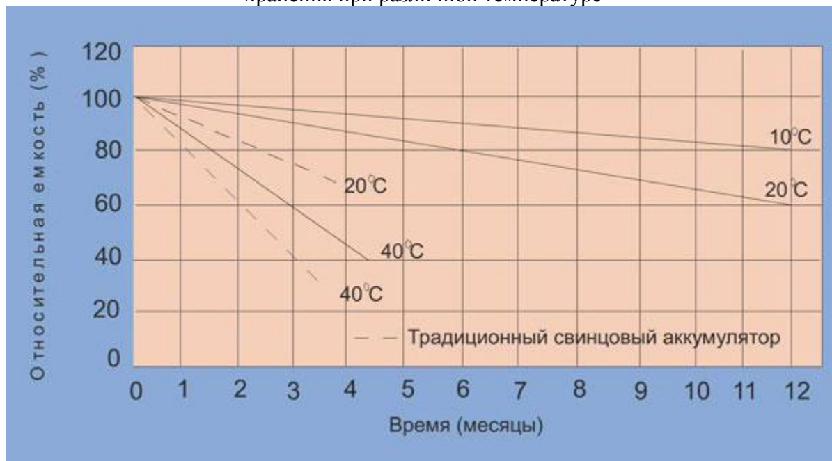
Рисунок 3 - Зависимость изменения емкости аккумулятора от времени хранения при различной температуре
