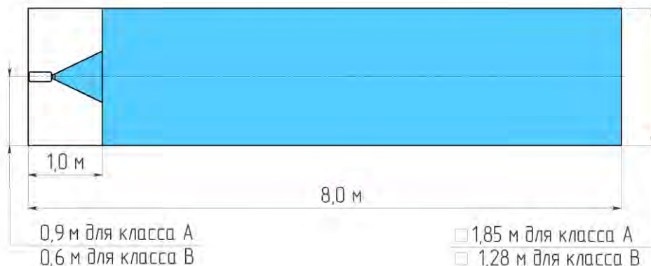
Рисунок 3 – Конфигурация зоны защиты модуля МПП, при горизонтальном монтаже модуля, для очагов класса «А» и «В»
