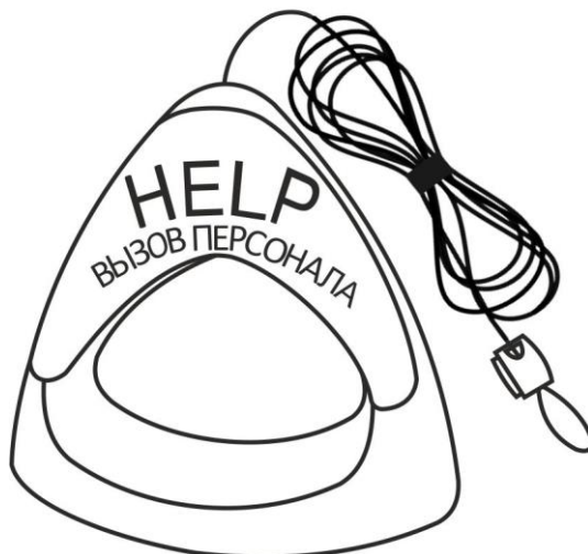
Рисунок 5.3. Дополнительная ручка со шнуром для кнопок вызова МР-060W1
