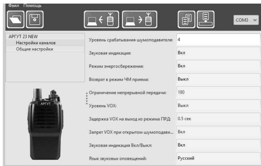
Рис. 9. Окно ПО настройки радиостанции.
