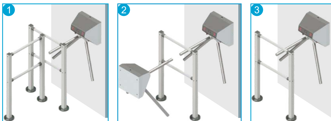
1 2 3 -турникет установлен правильно
