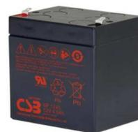
CSB серии GP1245 F2 - герметизированные, выполненные по технологии AGM, свинцово-кислотные аккумуляторные батареи общего применения со сроком службы до 5 лет в буферном режиме или 260 циклов заряда-разряда в циклическом режиме при 100% разряде. Эти высокоэффективные перезаряжаемые батареи не требуют обслуживания в течение всего срока службы.
