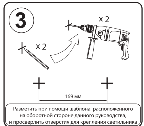
Дополнительное оборудование, которое понадобится для установки светильника
