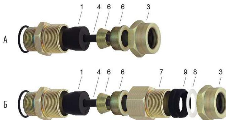
Кабельные вводы D12, D18: А – с устройством крепления бронированного кабеля (УКБК), Б – с герметичным УКБК (УКБКг)
