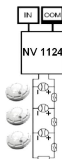
шлейф пожарных двухпроводных извещателей
