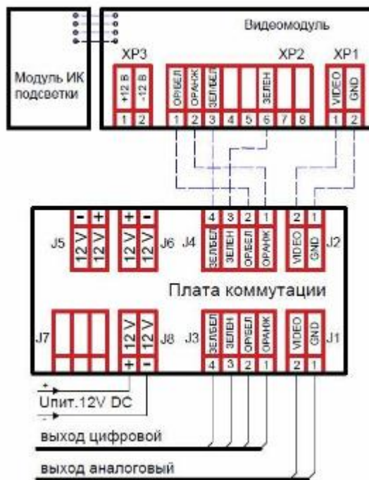
Рисунок 4.3 - Схема подключения термокожуха
