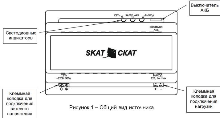
Рисунок 1 – Общий вид источника
