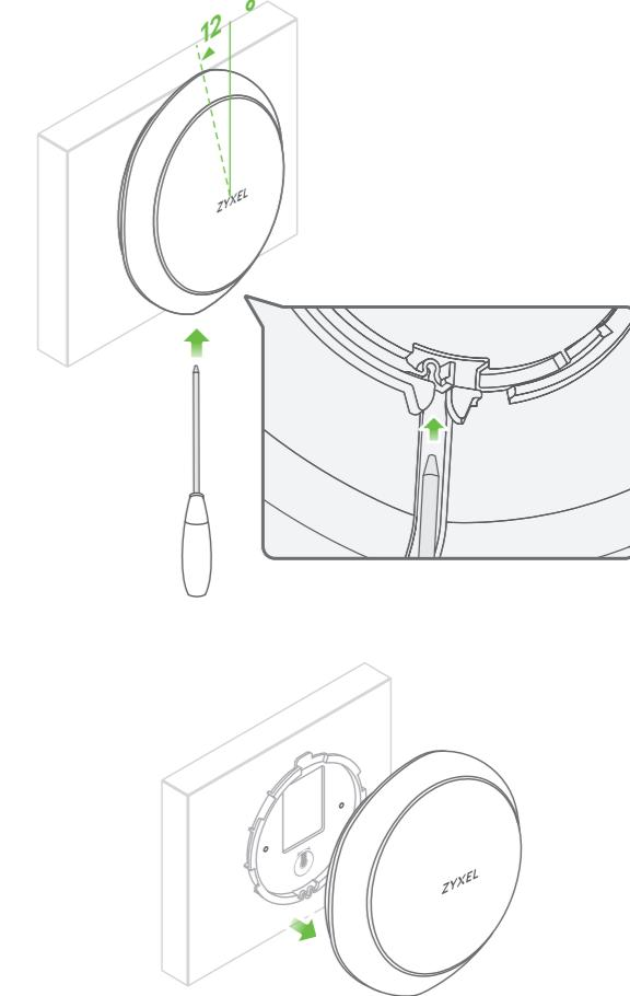
**SE** Använd ett tunt, platt verktyg (som en platt skravmejsel) för att trycka ned AP-låset. Vrid AP moturs för att frigöra.
