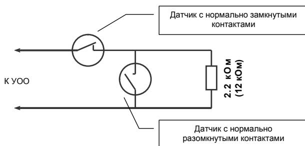
УОО поддерживает режим шлейфов без конечных резисторов (в этом случае датчики подключаются к УОО напрямую, последовательно или параллельно). Но использовать такой режим допустимо только для кнопок экстренного вызова, поскольку для датчиков скрытного проникновения он может быть саботирован.
