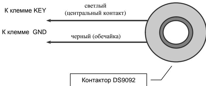
При использовании термодатчиков они также соединяются параллельно и подключаются к клеммам GND, KEY с учетом полярности. УОО поддерживает подключение до четырех термодатчиков; допустимо использовать типы DS18B20, DS18S20, DS1822 или аналогичные. Идентификация датчиков и их привязка к устройству осуществляются при программировании.
