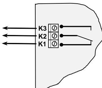
Клемма K1 - размыкающий контакт, K2 - общий, K3 - замыкающий. Контакты реле гальванически развязаны от остальной схемы УОО и могут быть подключены произвольным образом при соблюдении электрических ограничений (п. 2).
