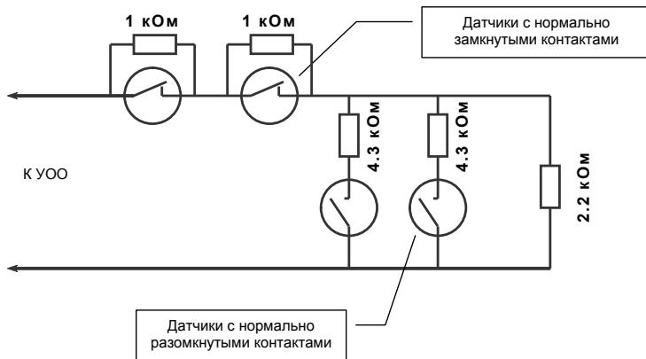
Датчики с нормально-замкнутыми контактами (размыкающие) включаются в шлейф последовательно, при этом параллельно каждому датчику устанавливается резистор 1 кОм. Датчики с нормально-разомкнутыми контактами (замыкающие) подключаются к шлейфу параллельно, при этом последовательно с каждым датчиком устанавливается резистор 4.3 кОм.
