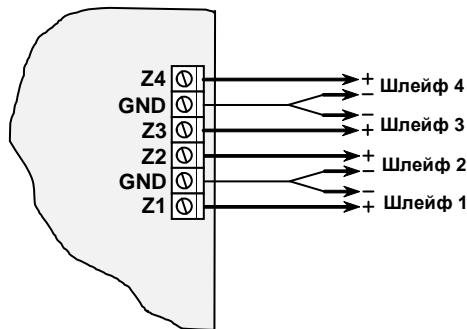
Включение в шлейфы датчиков разных типов показано на следующем рисунке. Замыкающие датчики должны устанавливаться в шлейфе параллельно, размыкающие – последовательно, в разрыв шлейфа; в каждый из шлейфов допускается устанавливать датчики любого типа, в том числе и обоих сразу. Количество датчиков в каждом шлейфе не ограничено, при соблюдении требований таблицы на стр. 6. На концах шлейфов должны быть установлены резисторы с мощностью рассеивания не менее 0.25 Вт, сопротивлением 2.2 кОм.
