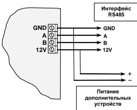
Подключение выполняется кабелем с двумя витыми парами, одна пара используется для соединений клемм GND и 12V, другая - клемм A и B. Одноименные клеммы всех устройств интерфейса должны быть соединены друг с другом.
