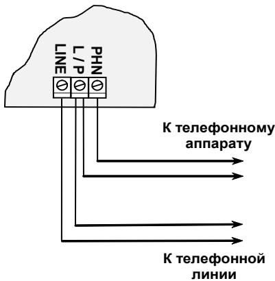
УОО включается в разрыв между телефонной линией и телефонным аппаратом (аппаратами). Не рекомендуется оставлять телефонный аппарат подключенным напрямую к телефонной линии, так как он может препятствовать передаче сообщений УОО.
