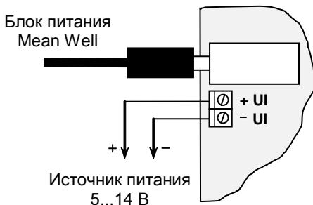
Блок питания Mean Well подключается к УОО посредством штекера, а внешний блок питания подключается проводами к клеммам УОО, с соблюдением полярности.
