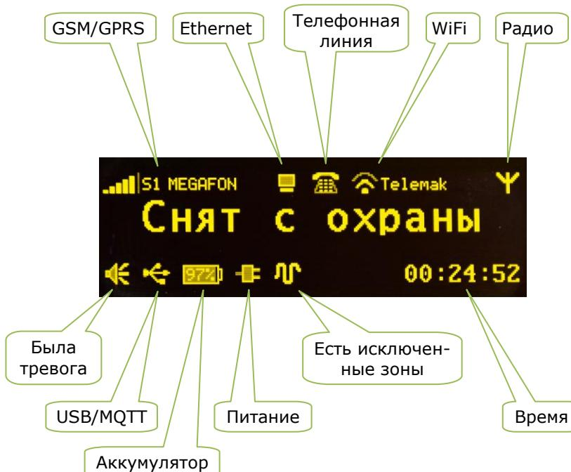
Центральное текстовое поле отображает текущее состояние УОО. В верхней части экрана отображаются иконки каналов связи УОО. Ес-
