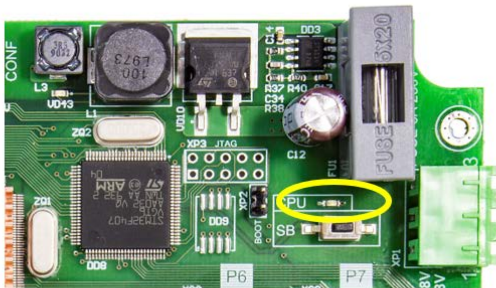
Рисунок 10. Расположение элементов индикации и настройки на плате коммутатора.
