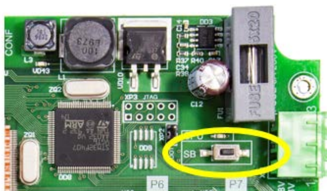
Рисунок 11. Кнопка сброса настроек коммутатора на заводские установки
