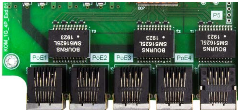
Рисунок 6. Порты Ethernet коммутатора
