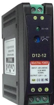
Индустриальный блок питания 12В / 1А (макс. мощность до 12 Вт). Входное напряжение AC 90...264 В, механическая подстройка выходного напряжения 11.5~14.5 В, интегрированная защита от перегрузок, коротких замыканий и избыточного напряжения, температурный диапазон -40°C ~ +70°C, вес 160г, размеры 23x80x103, пластик. Устанавливается на DIN-рейку TS-35/7.5 или TS-35/15
